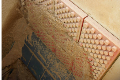
Abbildung: Prallkasten an der LKW Verladung in einem Kieswerk Nähe Köln
