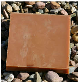
Abbildung: Polyurethan RWE PU i.d.R. in 90° Shore A
