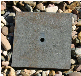
Abbildung: (Hart-)guss in unterschiedlichen Legierungen und Härten zwischen 55 und 62 HRc
