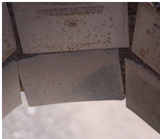
Abbildung: Kacheln an einem Auslauf aus Gummi und Hartguss
