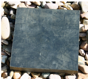
Abbildung: Gummi RWE GU i. d. R. in 60° Shore A
