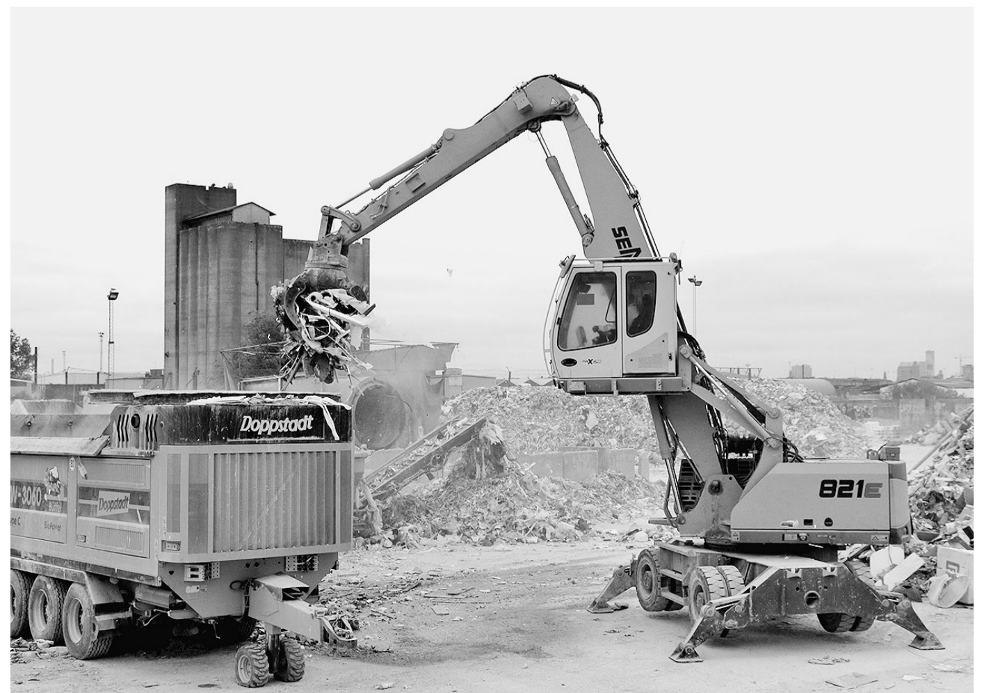
Zur Beschickung des Doppstadt Shredders wird der neue Sennebogen 821 vorrangig eingesetzt. Zudem unterstützt er die beiden 818 beim Sortieren und Verladen. FOTO: SENNEBOGEN
